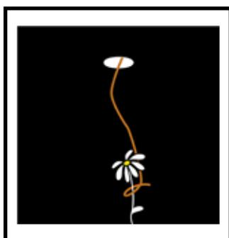
4 Geschützt gegen Zugang zu gefährlichen Teilen mit einem Draht.
